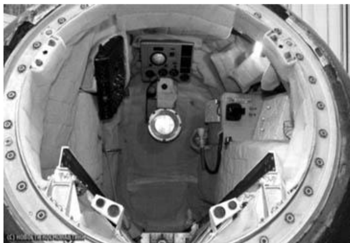
Foto 15a. Interior de la nave cósmica Vostok .
